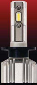
Le lampade LED modello D, compatibili con lampade di serie D1R/D1S, D2R/D2S, D3R/D3S e D4R/D4S, non vanno collegate al connettore originale Xenon ma devono essere alimentate tramite segnale accensione luci. Tale segnale può essere prelevato o a monte della centralina Xenon di serie o in uscita dal devio luci.
