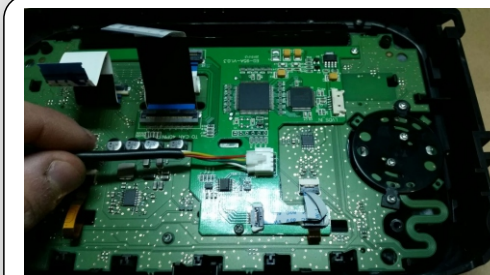
20. COLLEGARE IL CABLAGGIO CON IL CONNETTORE A 4PIN DI GESTIONE DEL TOUCH.
