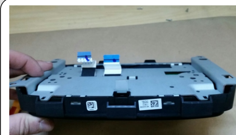
10. RIMUOVERE IL COPERCHIO IN METALLO DAGLI INCASTRI, PARTENDO DAI FERMI INFERIORI.
