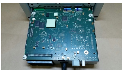
5. RIMUOVERE LA MAIN PCB DELLA RADIO SOLLEVANDOLA DALLA PARTE POSTERIORE. (E' FISSATA SENZA VITI)
