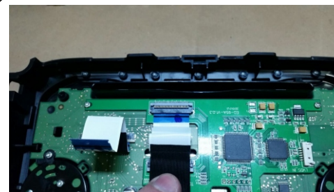
19. COLLEGARE IL FLAT DEL SEGNALE VIDEO DELLO SCHERMO SULLA PCB DEL CONNETTORE SIGLATO «TO LCD 40 PIN»
