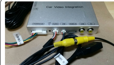
33. COLLEGARE ALLA CENTRALINA IL CONNETTORE DI ALIMENTAZIONE
