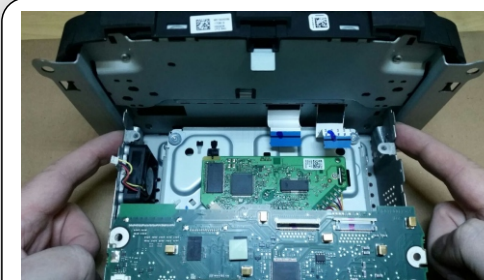
8. PREMERE LEGGERMENTE SUI 2 LATI DEL FRAME METALLICO. TALE OPERAZIONE SGANCERA' AUTOMATICAMENTE IL DISPLAY DAL TELAIO DELLA RADIO
