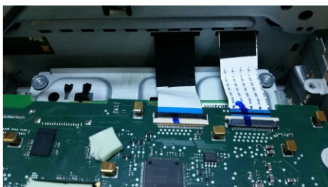
27. COLLEGARE I FLAT PROVENIENTI DAL MONITOR, VERSO LA MAIN PCB DELLA RADIO
