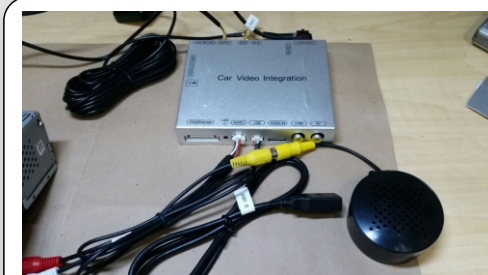
32. CONNETTERE ALLA CENTRALINA I CABLAGGI AUDIO CON L'ALTOPARLANRE ESTERNO E LA PRESA INGRESSO USB
