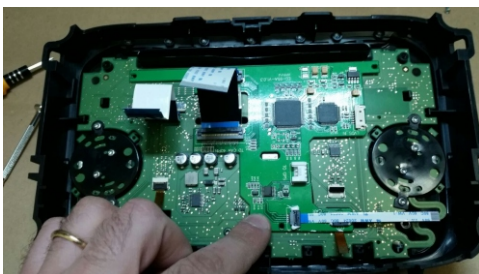
15. POSIZIONARE LA SCHEDA AGGIUNTIVA SULLA MAIN DEL MONITOR IN CONCOMITANZA DEI FORI DELLE VITI PRECEDENTEMENTE RIMOSSE.
