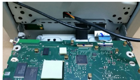
26. ASSICURARSI CHE I FERMI DEL TELAIO SIANO BEN SALDI AL MONITOR. DIVERSAMENTE ALLARGARE IL TELAIO IN MODO DA CREARE MAGGIOR PRESA
