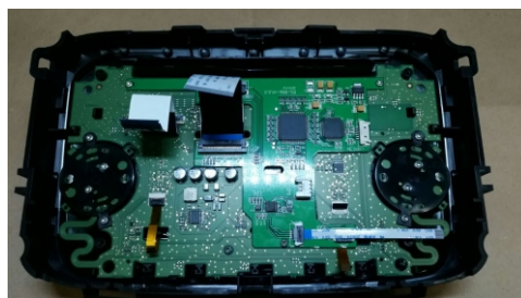
16. FISSARE LA SCHEDA AGGIUNTIVA CON LE STESS VITI RIMOSSE PRECEDENTEMENTE.
