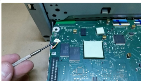
4. SCOLLEGARE IL CONNETTORE DELLA VENTOLA DI RAFFREDDAMENTO DALLA MAIN PCB
