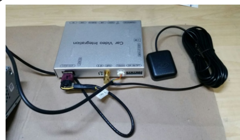
31. COLLEGARE I CABLAGGI DEL SEGNALE VIDEO, DEL TOUCH E DELL'ANTENNA GPS ALLA CENTRALINA
