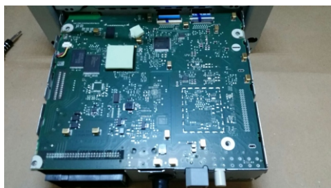
28. RIPOSIZIONARE LA MAIN NEL TELAIO CON CAUTELE E RICOLLEGARE IL CONNETTORE DELLA VENTOLA DI RAFFREDDAMENTO
