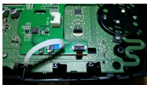
17. COLLEGARE IL FLAT ORIGINALE DEL TOUCHSCREEN SULA PCB
