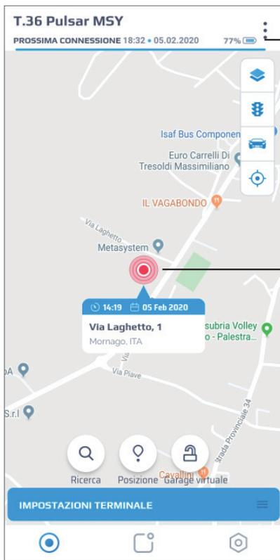
**PROSSIMA CONNESSIONE:** in base alle impostazioni scelte, viene mostrato quando avverrà il prossimo risveglio autonomo di **T.36 Pulsar** con connessione del dispositivo alla rete GSM.
