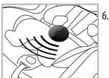
6. Display e sensore sono abbinati e il sistema è in funzione.
