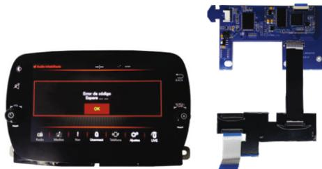
1. Rimuovete il monitor dalla vettura e aprite la cover posteriore per l'inserimento del PCB.
