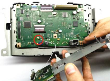
5. Rimuovete il filo di connessione fra la parte metallica e il PCB
