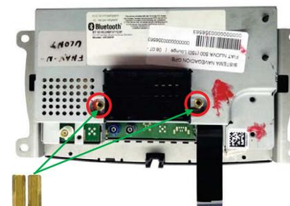
11. Riposizionare la copertura metallica fissandola con le viti originali. I due bulloni distanziatori vi permetteranno il fissaggio della PCB(rosso cerchiati)
