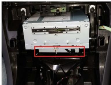
10.将解码器连接线与音响主机电源线/视频LVDS线对接,再将解码器固定在音响主机下方,如上图
