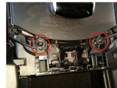
6.将音响控制面板上的两颗T20螺丝拧下
