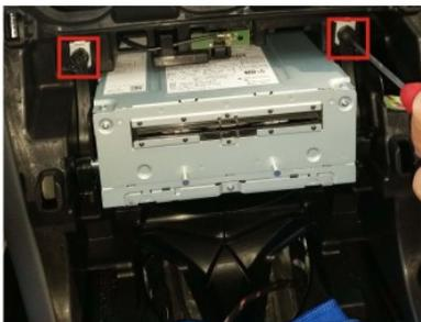
9.将固定主机的两颗T20螺丝拧下,再将固定塑料支架同时往外拉
