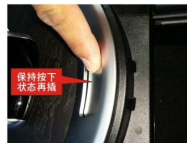
3.按下手扶箱开关将饰板左右两边撬起,再撬饰板后端塑胶板
