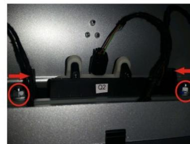
17.将后箱开关背后两处十号套筒螺丝拧出,再将开关左右两处卡扣往里顶即可拿出
