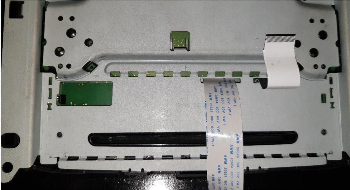
6) Fare passare il FLAT nell'apposito slot, Rimontare la scheda PCB, e rimontare il pannello di protezione del monitor.
