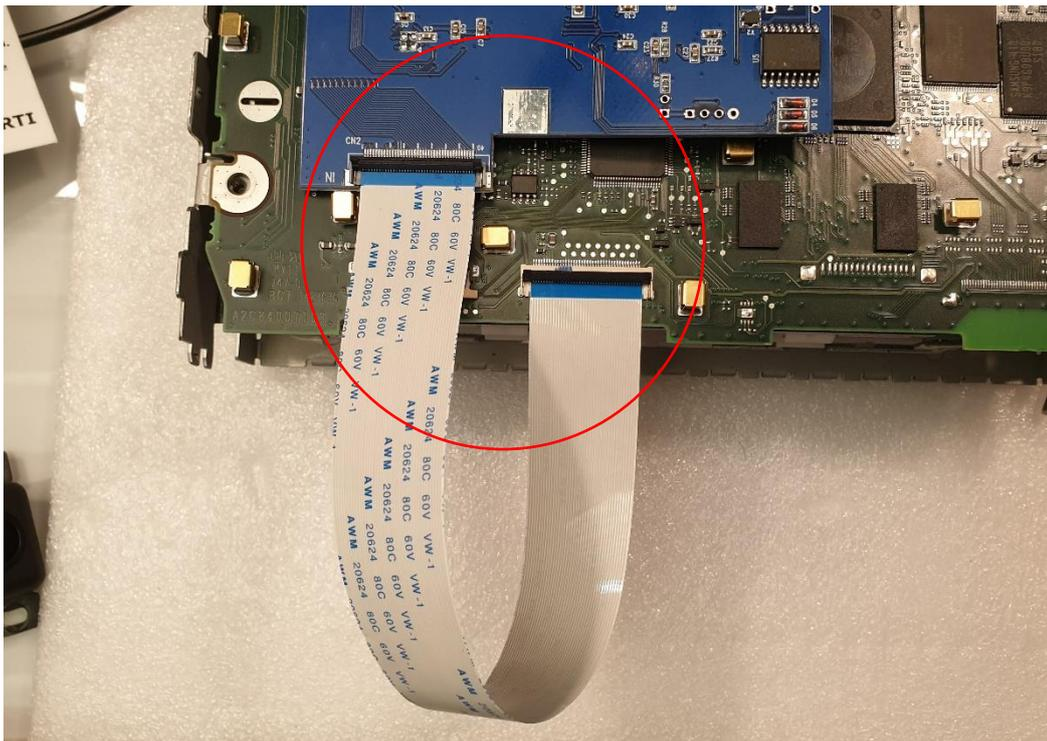
7) Collegare l'altro FLAT in dotazione dal connettore della radio originale, all "IN" della interfaccia, il tutto con i contatti del FLAT verso il basso come si può notare sulla foto.
