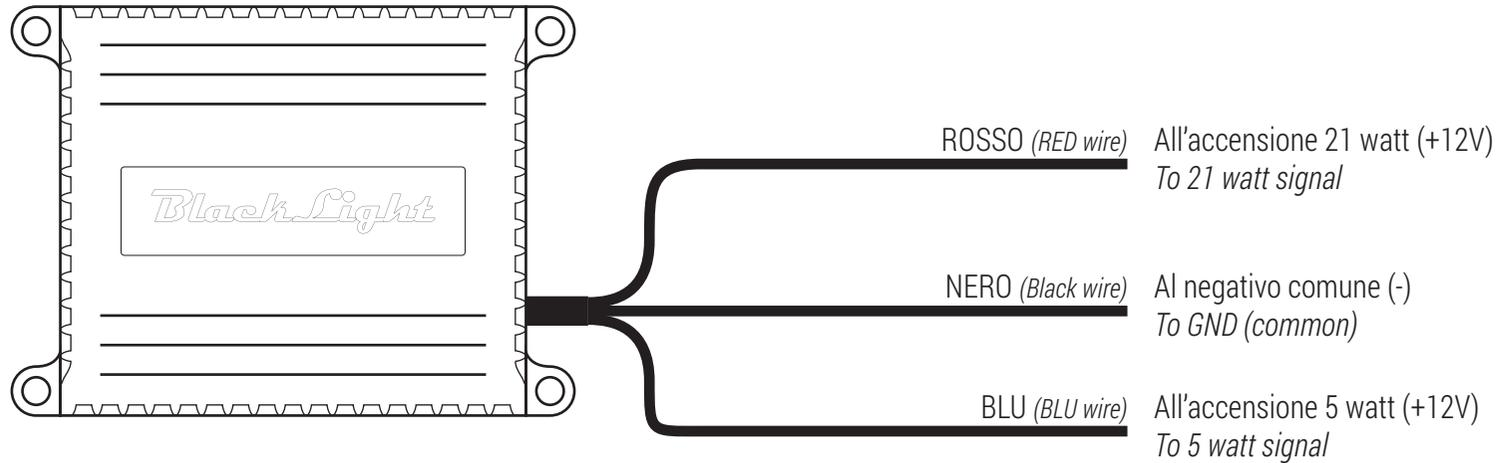
Il cavo di colore rosso della nostra centralina, va collegato in parallelo al cavo diretto al portalampada originale che fornisce l'accensione del filamento 21 watt della lampada W21/5W o P21/5W. Allo stesso modo, il cavo blu, va collegato al cavo diretto al portalampada originale che fornisce l'accensione del filamento 5 watt. Il cavo di colore nero, è il negativo comune dei due filamenti e va anch'esso collegato al cavo diretto al portalampada.
