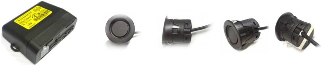
Il kit EasyPark è composto da una centrale che controlla quattro sensori passivi ed informa il conducente attraverso un altoparlante che emette una segnalazione acustica che incrementa la frequenza con l'avvicinarsi all'ostacolo.
