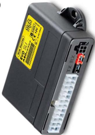
Per poter installare un sistema di allarme anti effrazione anche su quelle vetture per le quali non sia ancora disponibile la scheda tecnica per EasyCan Digital o Analog, abbiamo sviluppato il Nuovo Easy Can SLI (Self Learning Indicator) che, con una procedura di auto apprendimento dei segnali ON/OFF degli indicatori di direzione, permette l'inserimento e il disinserimento del sistema di allarme.
