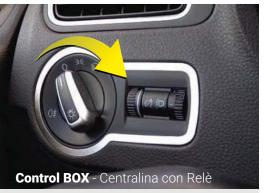
Il control box in dotazione con i DRL è in grado di rilevare l'accensione delle luci di posizione e anabbaglianti in modo tale da commutare automaticamente il DRL da luce diurna in luce di posizione o stazionamento e spegnersi o attenuarsi all'accensione degli anabbaglianti come da normativa
