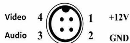
2) Definizione delle connessioni del cavo lato telecamera
