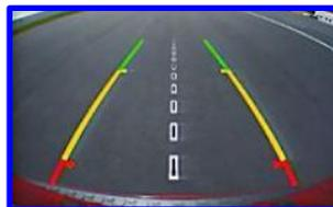
**Selettore linee guida in retromarcia on/off**
