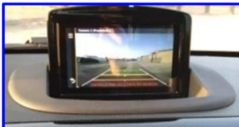
**Dispositivo AndroidAuto/CarPlay installato su monitor 7" motorizzato specifico per Fiat 500L con cruscotto come nella foto a lato (si elimina la presa d'aria posta sul pianale anteriore). Installabile su qualsiasi veicolo dove c'è spazio sul cruscotto. Apertura motorizzata.**
