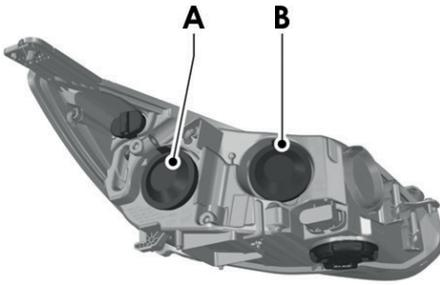
I tappi in gomma sono particolarmente utili qualora, dopo l'installazione di una lampada LED o Xenon, si debba necessariamente apportare modifiche al tappo originale del fanale (fig. A/B).
