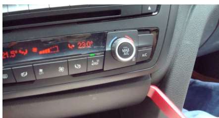
2. Sollevare e rimuovere la copertura sotto il climatizzatore
