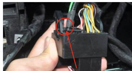
6. Rimuovere il cablaggio originale e togliere il cavo verde a 2 PIN
