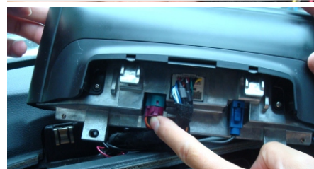
9. Connettere i cavi GPS, ISO, LVDS sul nuovo monitor LCD
