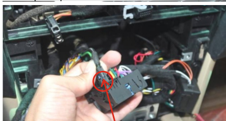
7. Inserire il cavo verde a 2 PIN nel cablaggio in dotazione
