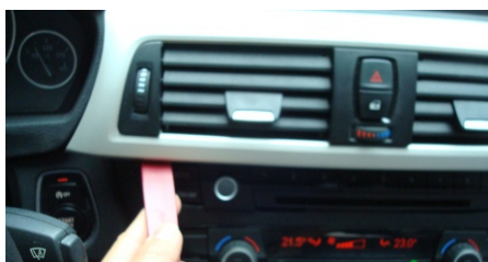
1. Sollevare e rimuovere il pannello di aereazione
