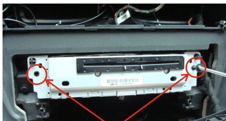
4. Rimuovere le 2 viti di fissaggio e togliere l'unità principale
