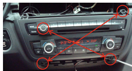
3. Rimuovere le 4 viti evidenziate e sollevare il pannello del sistema originale.
